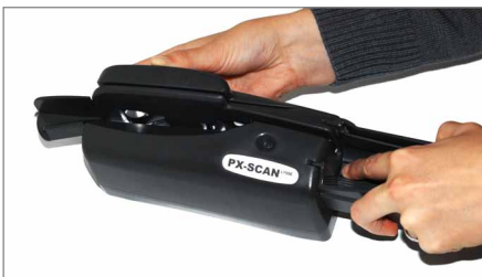
3. Um das Auffangfach zu entfernen, Verschluss nach unten drücken und Fach nach oben kippen und entfernen
